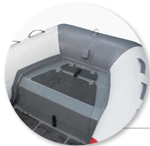
Double coffre avant avec réservoir 21 L
