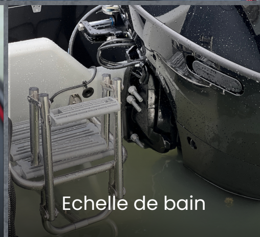
Vue arrière avec moteur Suzuki 200cv - commande électronique
